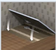
Bodengleiche Duschböden für den Einsatz bei Holzkonstruktionen – TUB H
