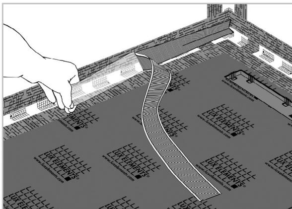
3 – Positionieren des Schnittschutzbandes und Verklebung während des Abziehens der Klebeschichtabdeckung
