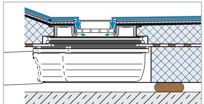
**■ Ablaufstutzen DN 50 waagrecht mit herausnehmbarem Geruchsverschluss**
