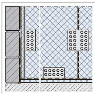
**1** Le support doit être plan, sec et propre. Si nécessaire, les surfaces irrégulières doivent être égalisées avec un ragréage.
