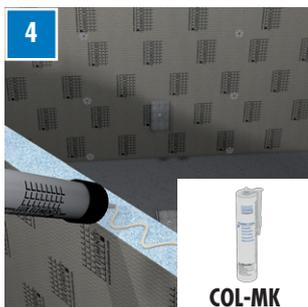
Élément porteur en mousse dure dans l'épaisseur souhaitée – élément conseillé: ELEMENT-EL 80 – recouvrir le champ de COL-MK ...
