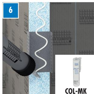
Pour des murs plus longs: introduire les profils de raccord appropriés – p. ex. MONT-H – et appliquer COL-MK sur la face avant.
