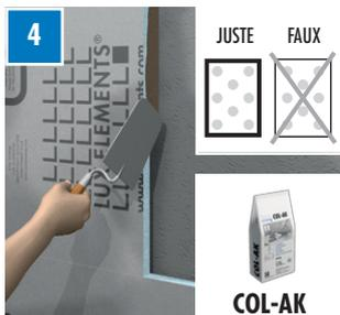
**4** Enduire les bords des panneaux de construction ELEMENT-VK avec colle d'application COL-AK, de façons à colmater les vides entre panneaux et mur, aussi pour coller les différents éléments entre eux.
