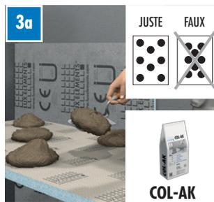
**3a** Selon le degré de planéité du support, appliquer la colle d'application COL-AK localement en posant des plots de colle (6 à 8 par m<sup>2</sup>) sur l'un des deux côtés.
