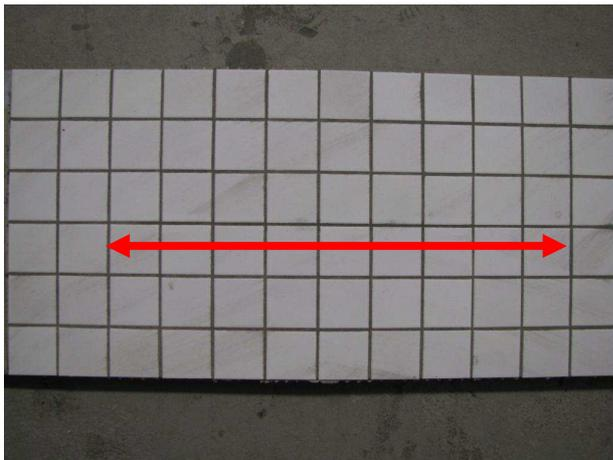
Nach Beendigung des Versuchs bei 18250 Überrollungen konnten **keine** optischen Schäden an der Keramikoberfläche des Prüfkörpers festgestellt werden.
